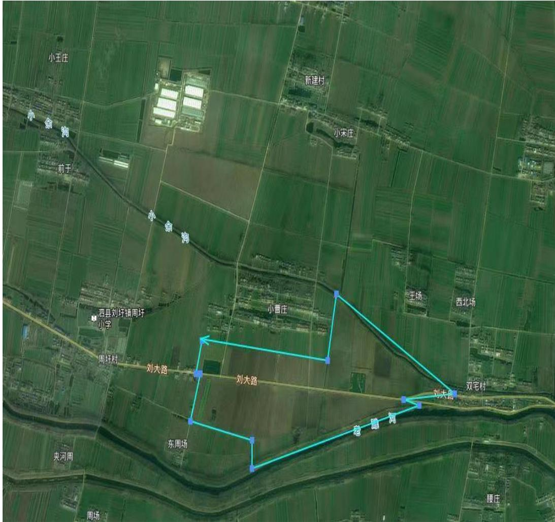
附图10 沼液输送管线
