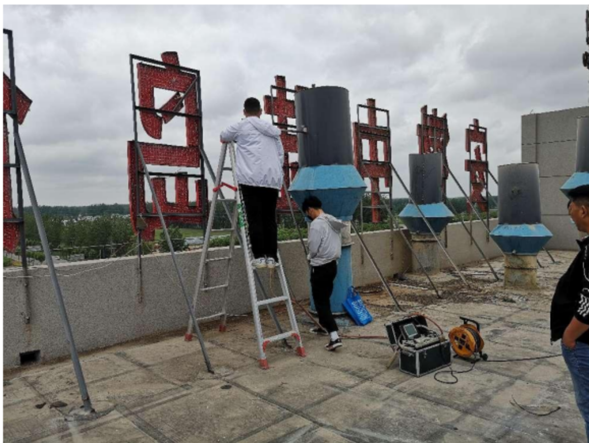
3#制粉一排气筒检测采样
