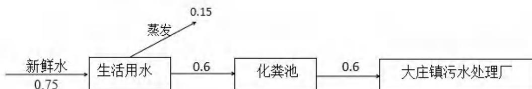
图 2-1 项目水平衡图 (m<sup>3</sup>/d)
