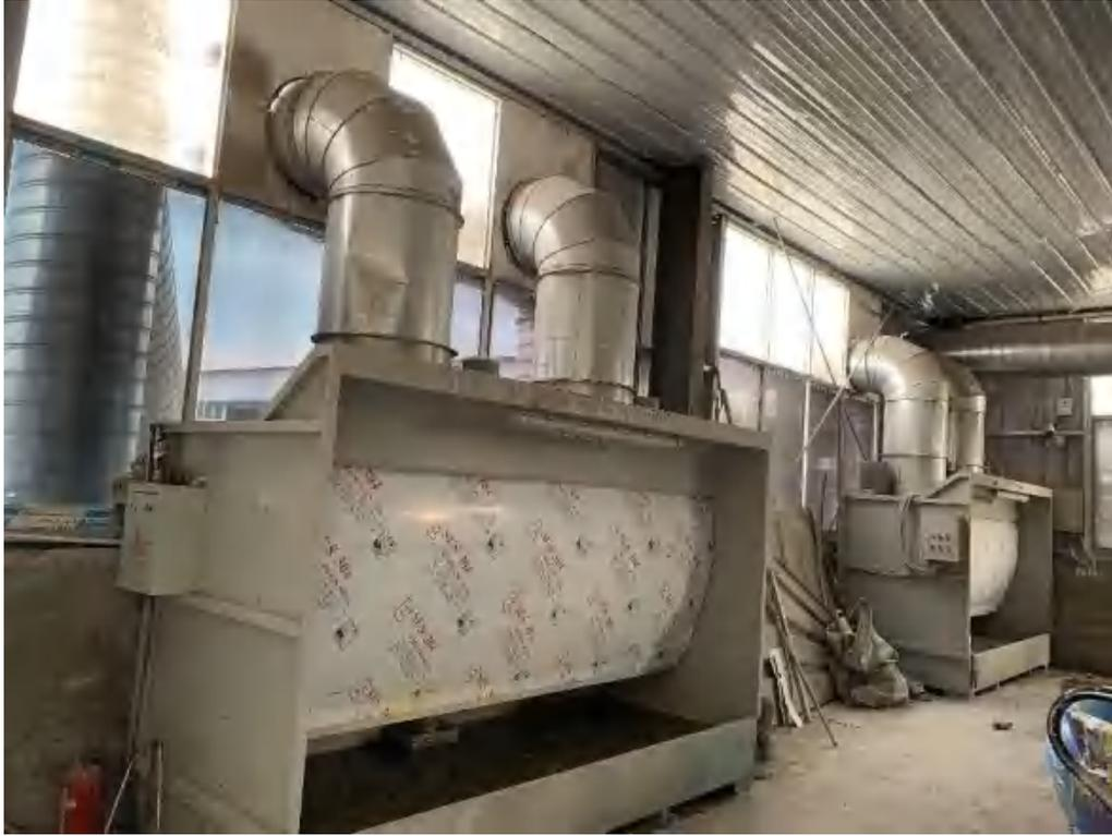
喷漆房房顶设置挡板降低房间高度减少空间
