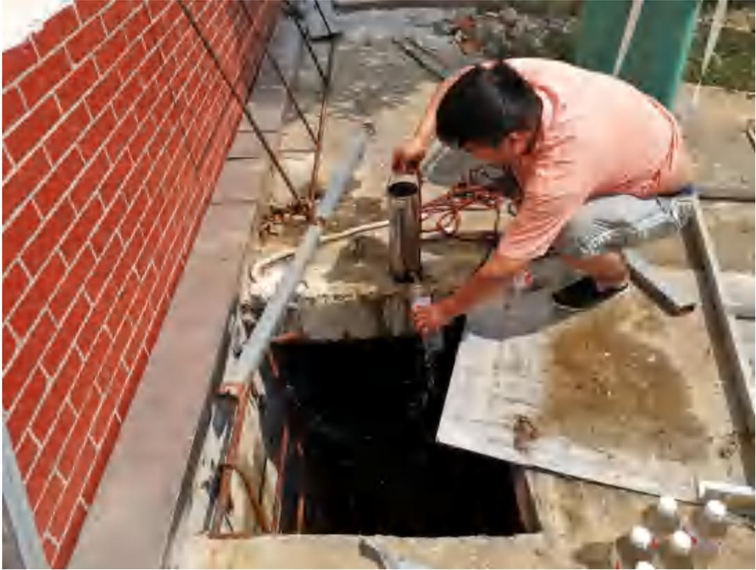
进水口废水采样检测
