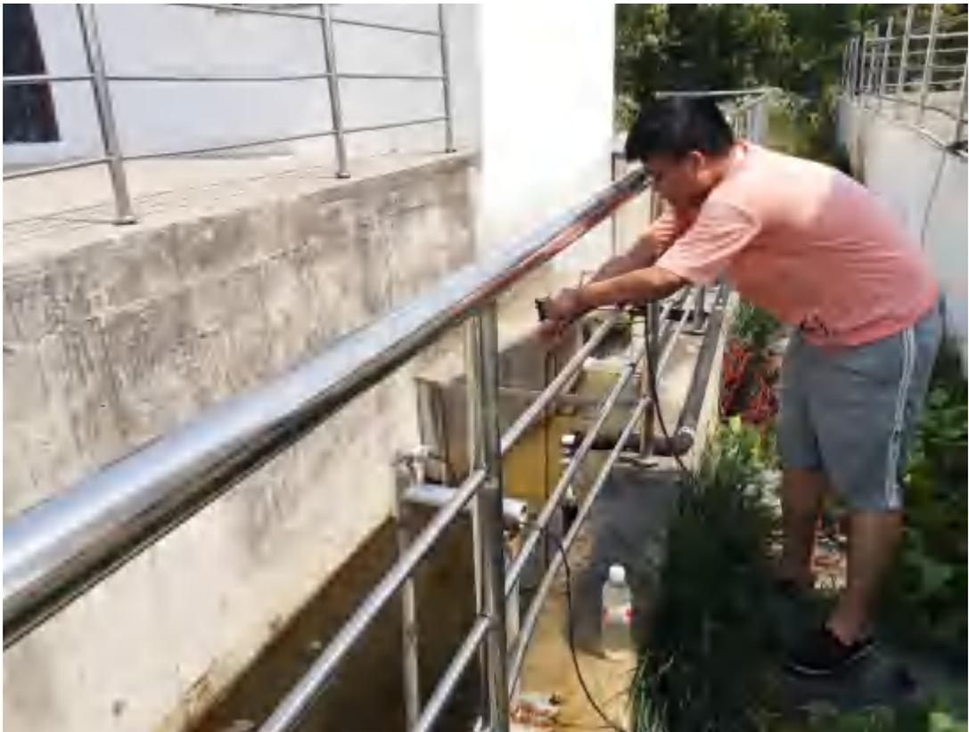
出水口废水采样检测
