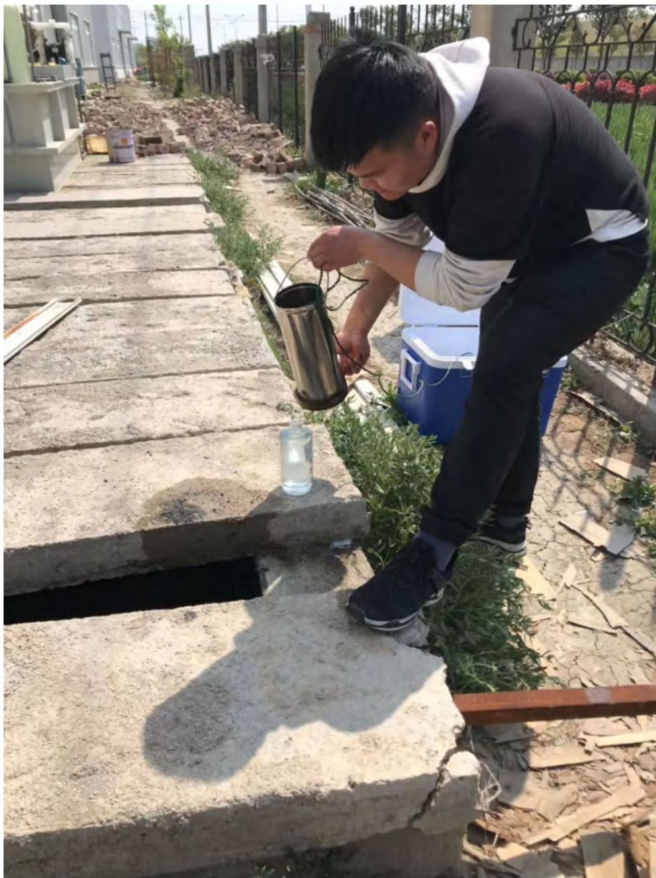
厂区废水检测采样
