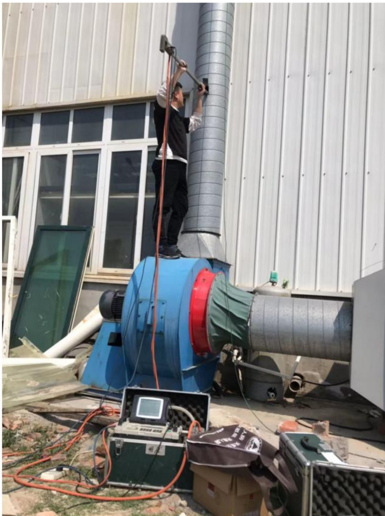
有机废气排气筒检测采样
