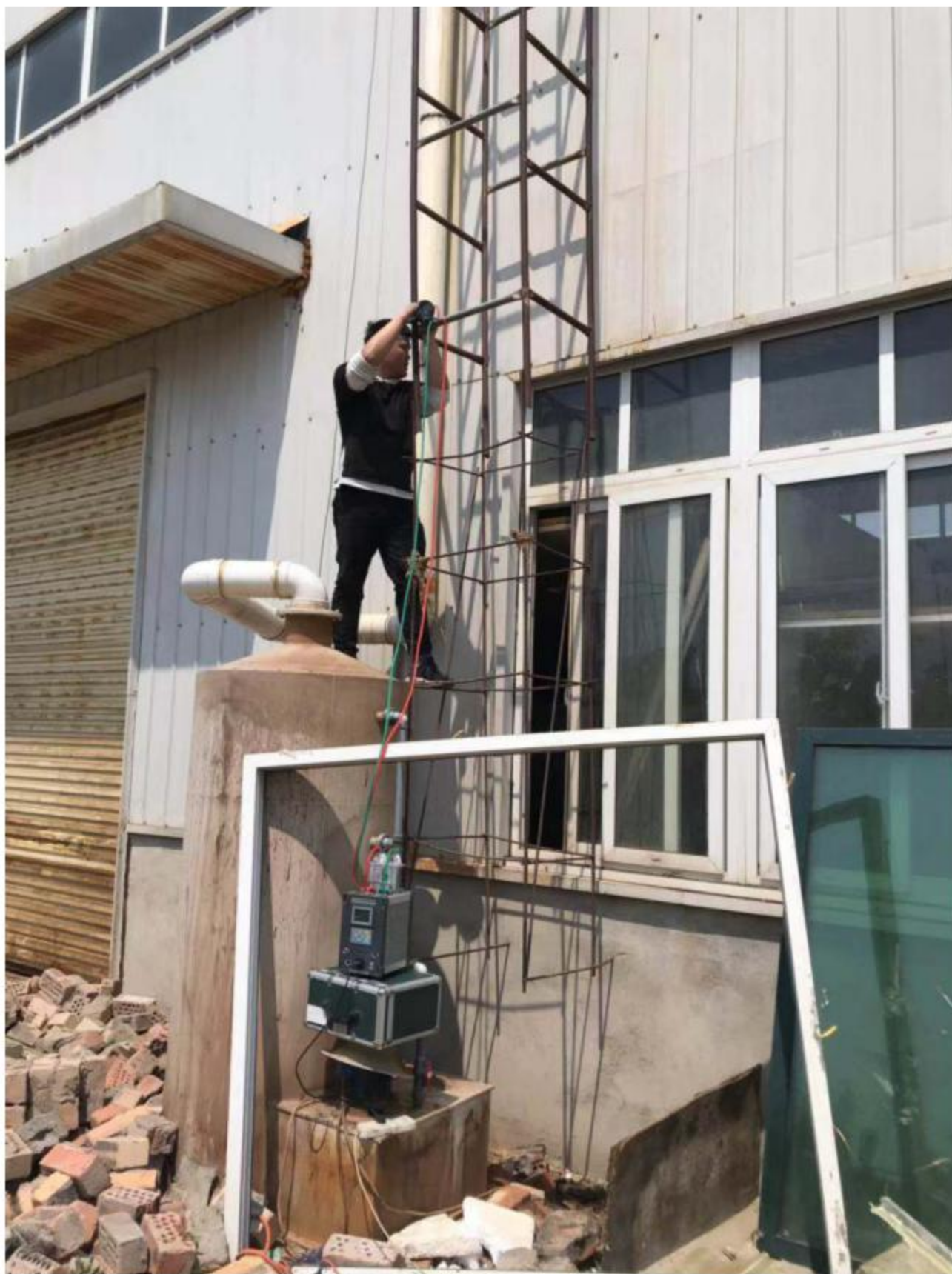
氯化氢废气排气筒检测采样
